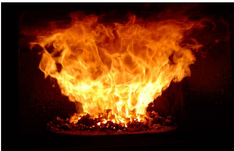
Obrázek 17. Práce retortového hořáku během vytápění uhlím Ling 75kW.
