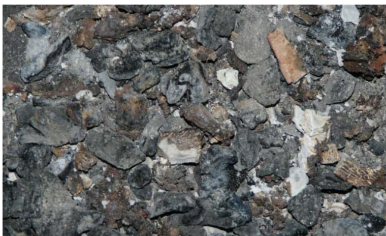
Obrázek 18. Spékání uhlí – špatné nastavení hořáku v poměru k jakosti paliva.
