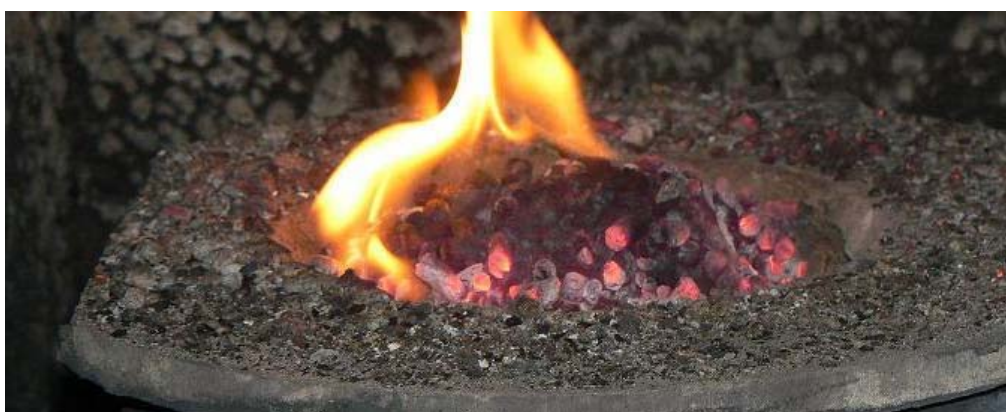
Obrázek 20. Poloha pelet na retortovém hořáku při provozu kotle. Ling 15–50kW.
