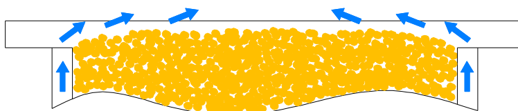
Obrázek 19. Poloha pelet na retortovém hořáku při provozu kotle.
